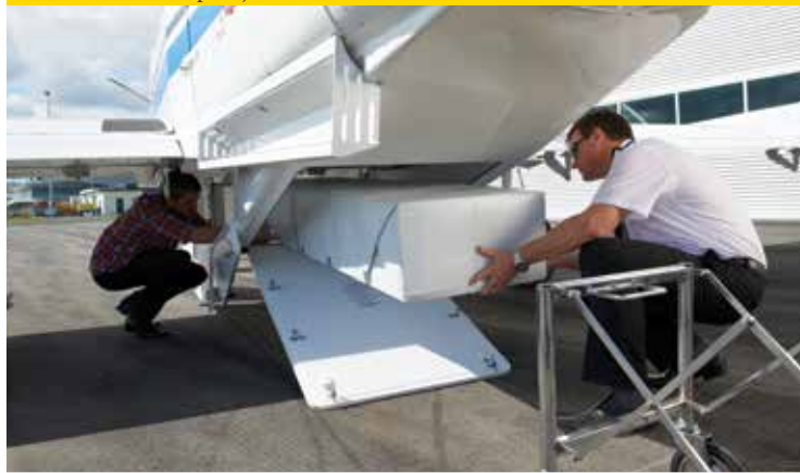
O compartimento ventral de carga tem acessos laterais ou por trás e pode ter ou não redes internas de separação de volumes, tornando extremamente versátil o seu uso.
